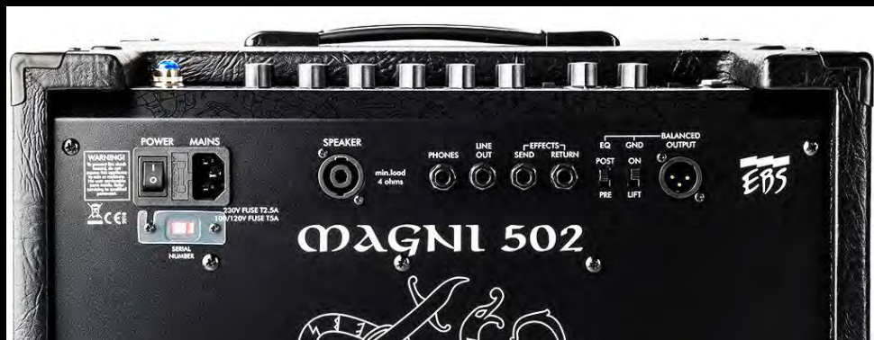
På baksidan av Magni 502-115 finns allt ifrån en effektloop till en balanserad XLR-utgång, hörlursutgång samt möjligheten att koppla in en extern 4 Ohmslåda.
